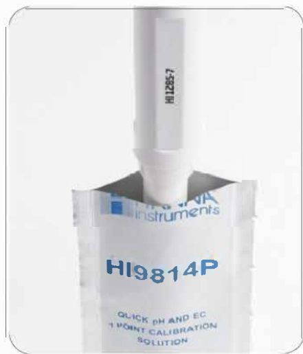
Calibración de pH y CE con una solución Quick Cal.
